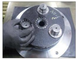
9) Disassemble Sun gear No.2 (70).
